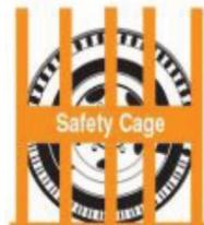
**Après avoir installé le pneu sur la jante, placez-le toujours dans une cage de sécurité répondant aux exigences de l'OSHA. Une fois dans la cage, il est possible de gonfler le pneu.**
